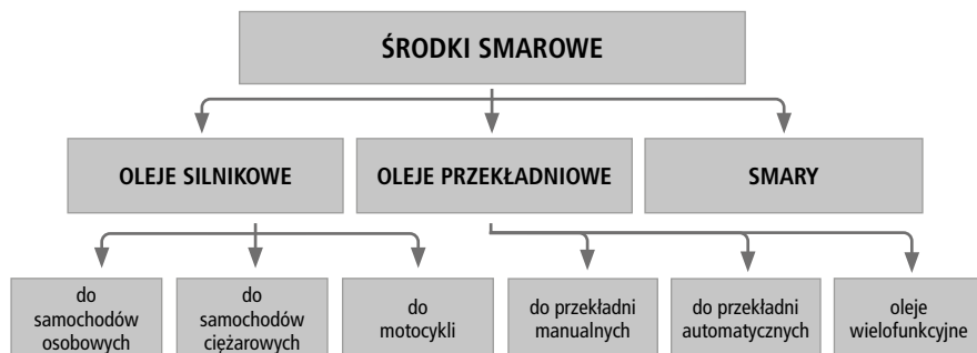
Rys. 1 Podział środków smarowych dostępnych na stacjach paliw
