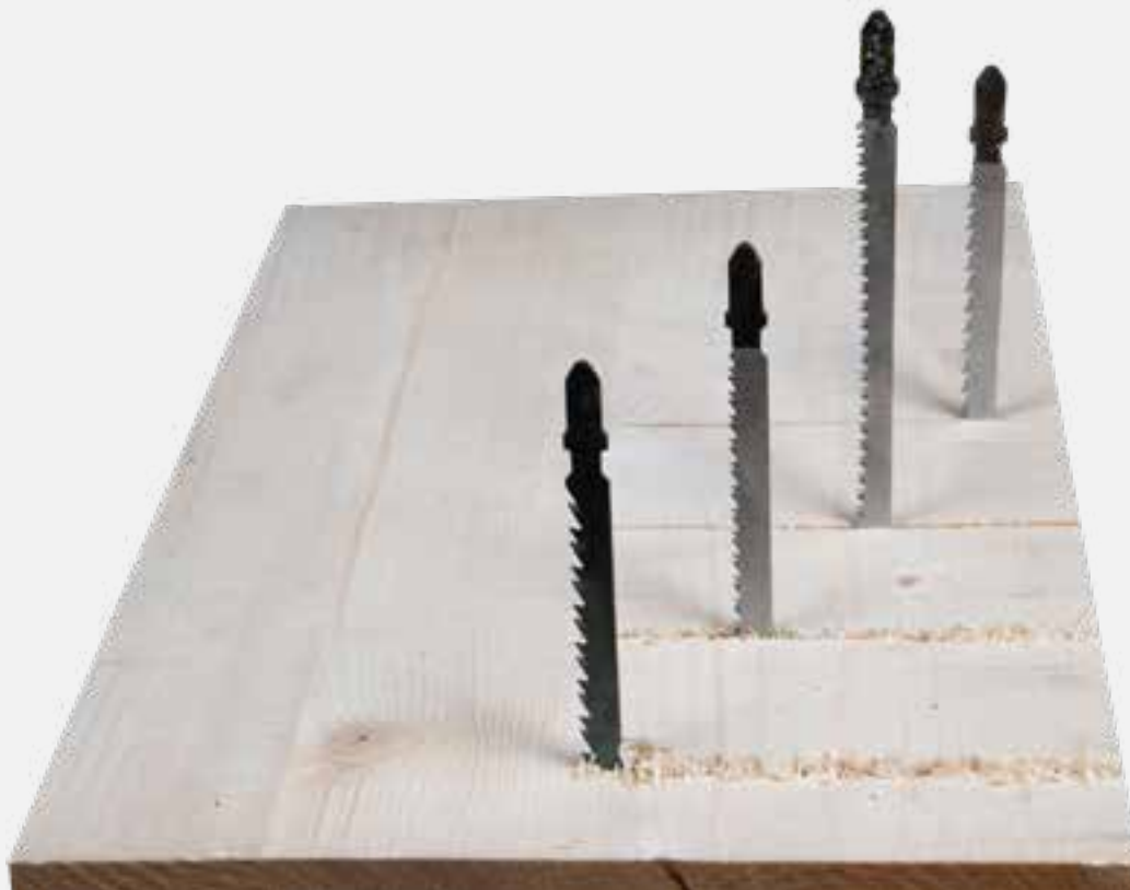
Bezodpryskowe cięcie na górnej stronie materiału
