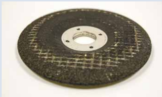
Obraz błędnego szlifowania tarczą do szlifowania (za płaski kąt przyłożenia)
